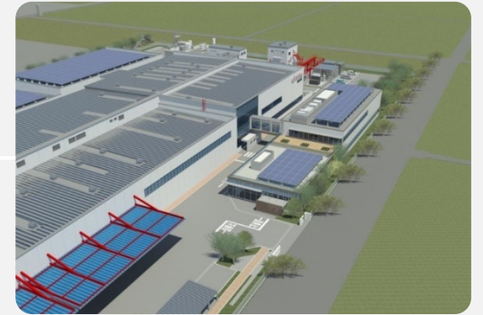
環境配慮設計：年間想定使用電力量の 約10%を太陽光にて発電
